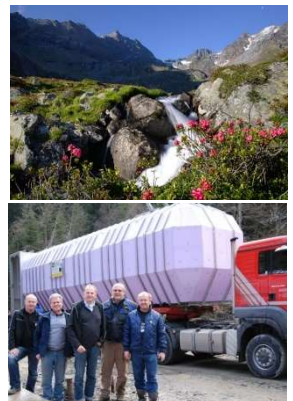
Bild: Transport eines 160 Kubikmeter fassenden Trinkwasserhochbehälters der Wassergenossenschaft Saalbach-Dorf
